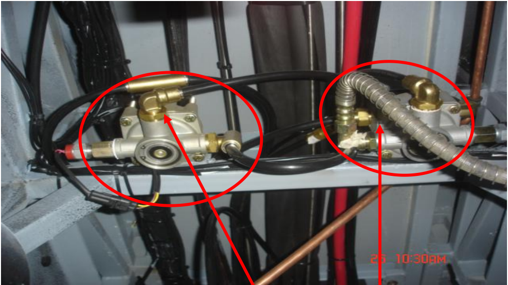
附图二 车底喷涂前部件遮蔽
